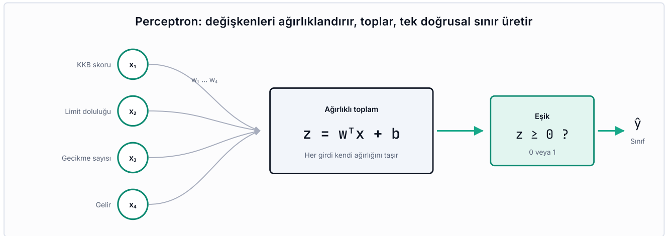
Şekil 1. Perceptronun girdi, ağırlıklı toplam ve eşik adımları.
